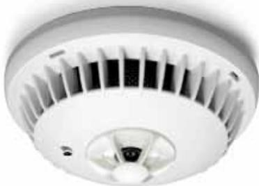
Rilevatore termico con comportamento differenziale e di massima risposta per loop3000 per il riconoscimento e la segnalazione precoci incendio in condizioni ambientali difficili, con un sensore termico ed un isolatore bidirezionale in accordo alle EN 54-5 e EN 54-17.
