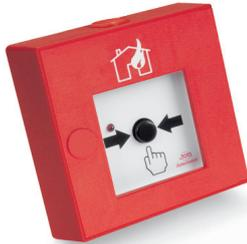
Pulsante di segnalazione incendio per loop3000 per l'attivazione manuale di un allarme con isolatore bidirezionale e indicatore di stato tramite LED in accordo alla EN 54-11. Involucro rosso in plastica con simbolo "casa in fiamme".
