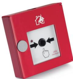
Pulsante di segnalazione incendio per loop3000 per l'attivazione manuale di un allarme con isolatore bidirezionale e indicatore di stato tramite LED in accordo alla EN 54-11. Involucro rosso in alluminio con simbolo di "casa in fiamme"
