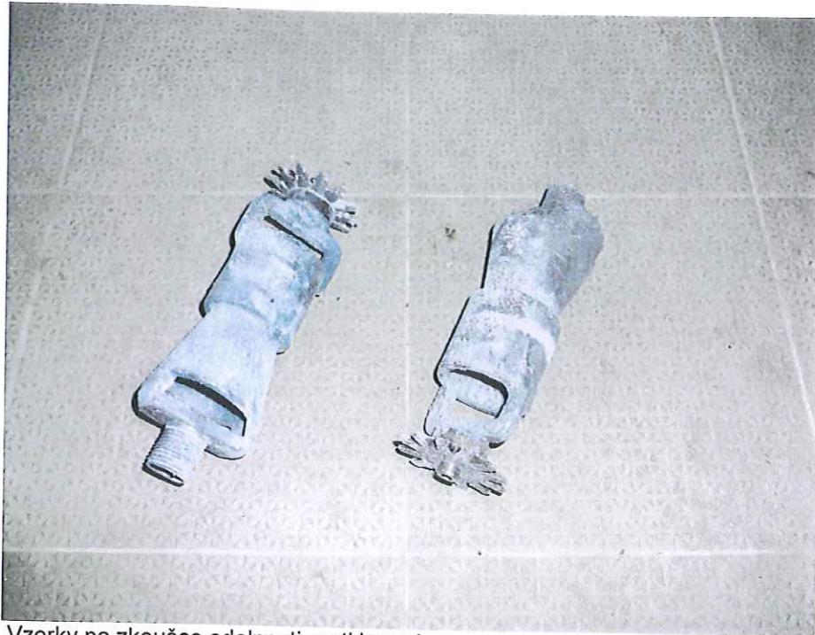
Vzorky po zkoušce odolnosti proti korozi
