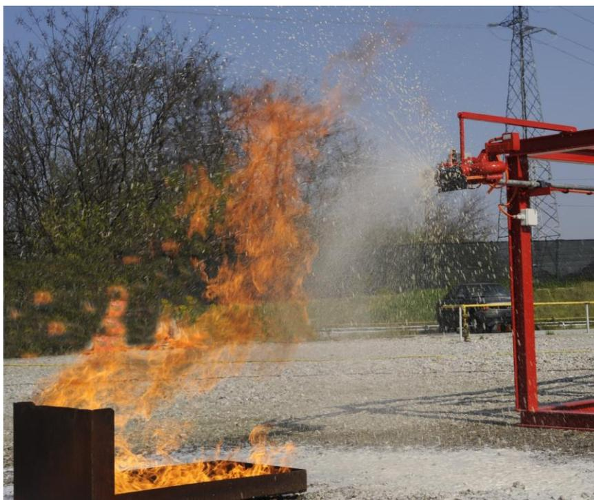
I monitori miniaturizzati, che realizzano la loro funzione di spegnimento spruzzando una miscela contenente schiumogeno antincendio, lavorano a una pressione ridotta e sono in grado di irrorare nel tempo tutta la cubatura del veicolo.
