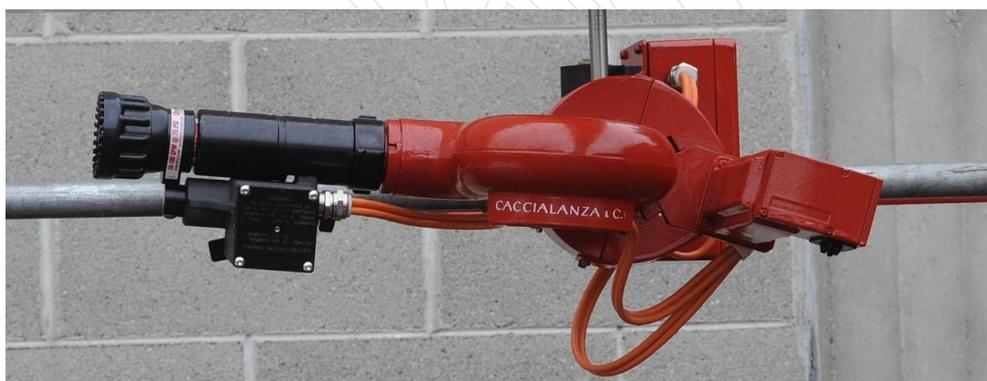
Il modulo può quindi essere collegato, attraverso un giunto a T di cui è dotato, alla tubazione da 1" proveniente dal modulo centrale e alla tubazione sempre da 1" di collegamento ai successivi moduli spegnimento.
