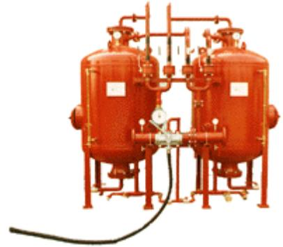
I miscelatori a spostamento di liquido a portata variabile regolano automaticamente il corretto estratto di regolazione della miscelazione schiuma a un flusso d'acqua in un campo variabile 1:8 (per esempio lo stesso miscelatore schiuma è adatto per miscelare automaticamente la corretta regolazione di miscelazione del liquido schiumogeno in un sistema schiuma entrambi a 8 monitori se solo il monitor è in funzione singolarmente e se tutti i monitori operano simultaneamente).
