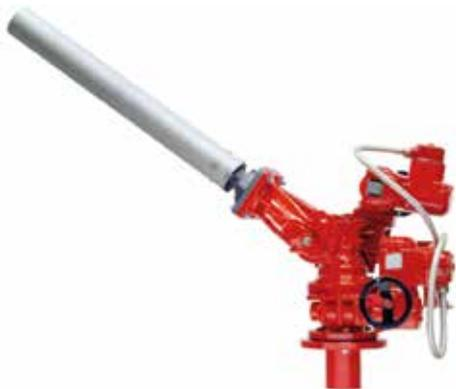
Löschrohren und zwei getrennten Einlaßflanschen, eines für Wasser/Schaummittelgemisch und eines für Trockenpulver, ausgerüstet. Im Inneren des Monitors erfolgt der Transport der Löschmittel in einer Art Koaxialrohr ohne Verbindung zwischen den Rohren.
