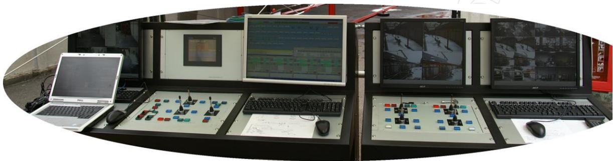
Das gesamte System ist mehrplatzfähig. Durch den redundanten Aufbau des lokalen Netzwerkes (in Verbindung mit einem drahtlosen LAN (WLAN)) können die Visualisierungen der gesamten Anlage in getrennten Räumen erledigt werden.
