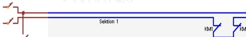
Eine blaue Linie kennzeichnet eine stromführende Verbindung. Die Anzeige von KM1 bis KM4 zeigt den aktuellen Status der entsprechenden Relais an.
