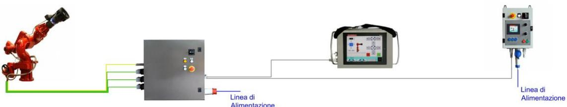
An das gleiche Stromversorgungs-Panel, mit oder ohne lokale Bedienelemente, kann ein weiterer Monitor angeschossen werden.
