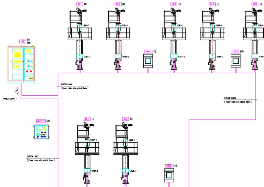
Die Abbildung zeigt die schematische Darstellung eines Systems mit 7 Monitoren, 3 festinstallierten und einer portablen Kommando-/Steuerpanele.
